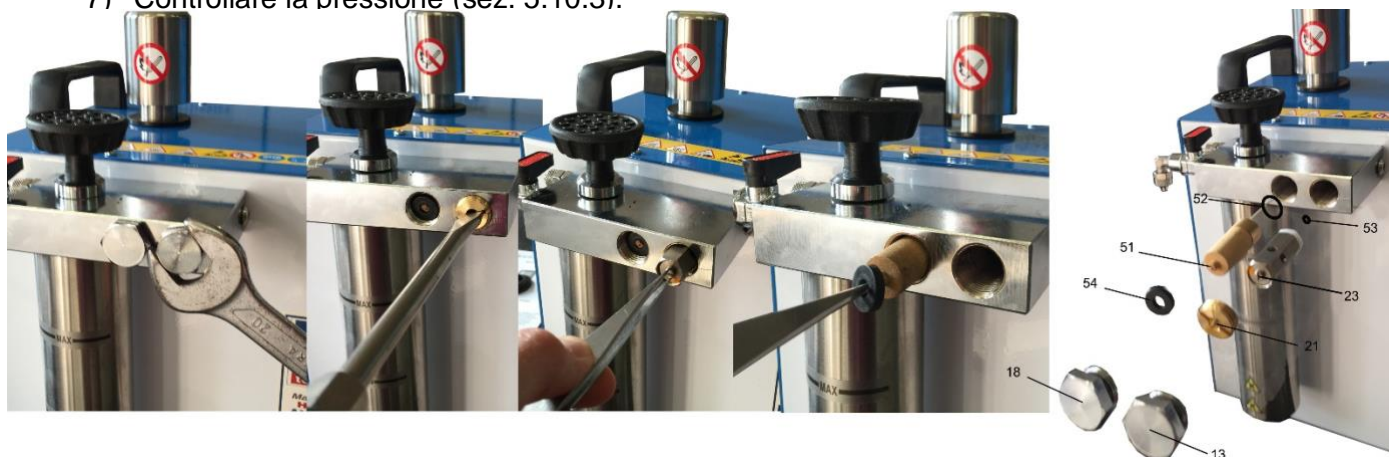
FIG 4 – SOSTITUZIONE VALVOLA E FILTRO D'ARRESTO
